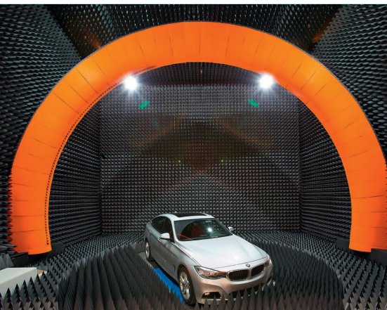
In einer Antennen-Test-Kammer kann gemessen werden, ob die 360-Grad-Abdeckung auch wirklich erreicht wird. © Molex
